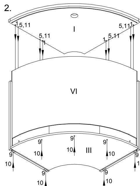
Соединить нижнюю полку с боковинами и затянуть отверткой, поворачивая по часовой стрелке, стяжки-эксцентрики (2) на нижней полке (см.рис.1). Поставить каркас на опоры и под пятники. Если каркас не стоит на под пятниках или наоборот, опоры (10) не достают пола, отрегулировать горизонтальное положение нижней полки, подкрутив опоры (10) (см.рис.2).
