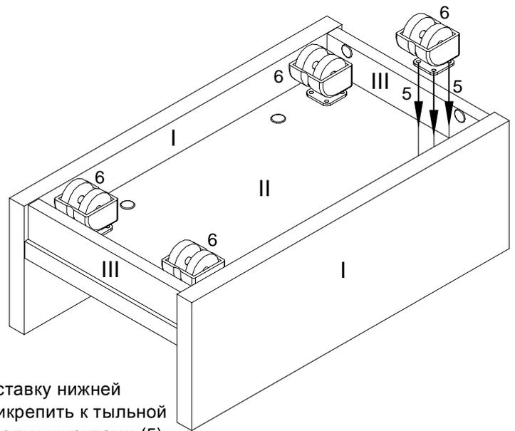
Перевернуть подставку нижней полкой вверх. Прикрепить к тыльной стороне нижней полки шурупами (5) роликовые опоры (6).
