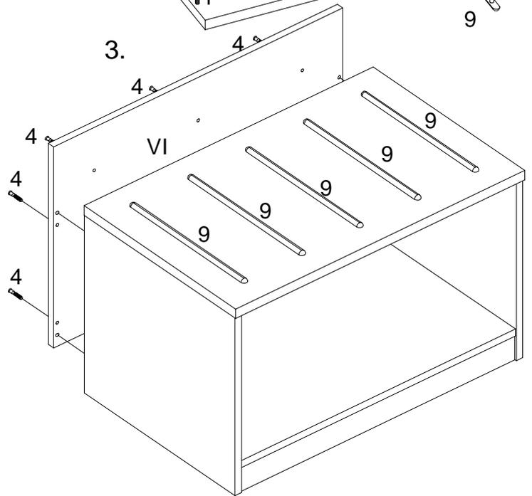
Соединить полку верхнюю (I) со стенками боковыми (II,III), завернуть стяжки-эксцентрики в стенках боковых (II,III). Соединить стенку заднюю (VI) с собранной конструкцией, вставить в отверстия на стенке задней стяжки директа (4) и завернуть их до упора (см. рис. 3). Вставить в стяжки-эксцентрики заглушки (8).
