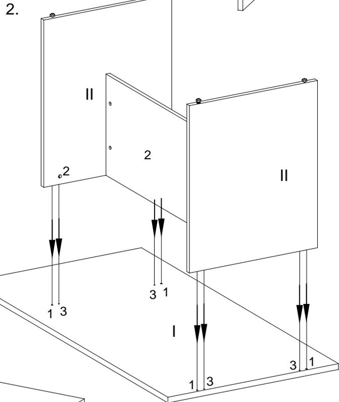
2. Стол рекомендуется собирать на столешнице. Положить столешницу отверстиями вверх. Забить в столешницу шканты (1) и вкрутить дюбеля стяжек-эксцентриков (3). Соединить каркас со столешницей и затянуть отверткой стяжки-эксцентрики (2) на боковинах. Закрепить торцы стяжек-эксцентриков декоративными заглушками. Установить стол. При необходимости отрегулировать положение стола опорами.
