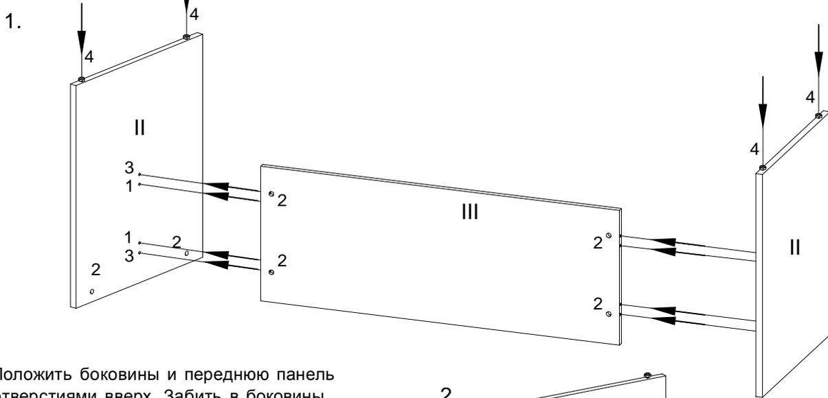
1. Положить боковины и переднюю панель отверстиями вверх. Забить в боковины регулируемые опоры с крепежем(4). Забить в боковины шканты (1) и вкрутить дюбеля стяжек- эксцентриков (3). Вставить в боковины и переднюю панель стяжки-эксцентрики (2) стрелкой в направлении отверстия на торце. Соединить боковины с передней панелью. Стянуть каркас, поворачивая стяжки-эксцентрики (2) на передней панели с помощью отвертки.
